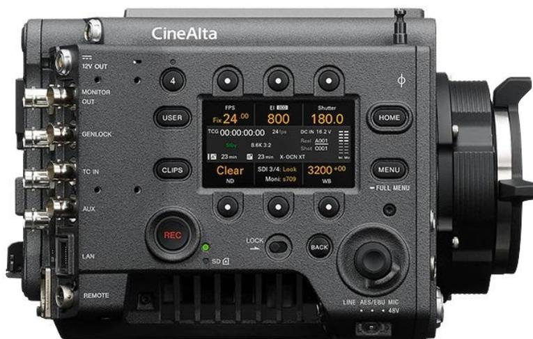
En réponse aux retours des utilisateurs, l'interface de menu a été mise à jour pour permettre une utilisation encore plus facile sur le plateau. Plusieurs des connecteurs de la VENICE 2 ont également changé d'emplacement et de type, par exemple la sortie 12 V Lemo et le connecteur Ethernet, qui se trouvent désormais du côté assistant de la caméra.
